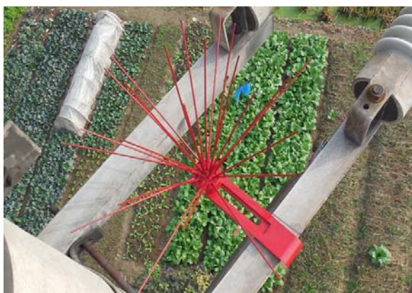
图 3 底座上开槽使针座可以调节
